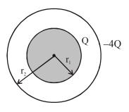
$$V_{in} - V_{out} = \left(\frac{kQ}{r_1} - \frac{4kQ}{r_2}\right) - \left(\frac{kQ}{r_2} - \frac{4kQ}{r_2}\right)$$
