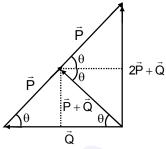
So angle between  $(2\vec{P} + \vec{Q})$  and  $\vec{Q}$  is  $90^\circ$ अतः  $(2\vec{P} + \vec{Q})$  तथा  $\vec{Q}$  के मध्य कोण  $90^\circ$  है।
